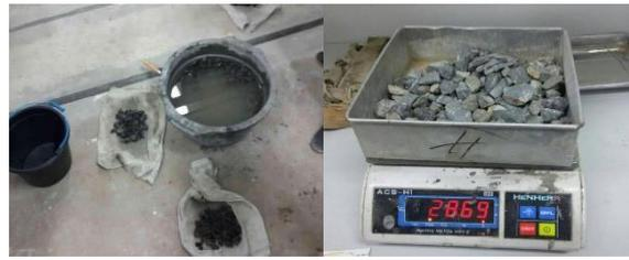
Gambar 11. Perendaman agregat dan penimbangan agregat andesit
