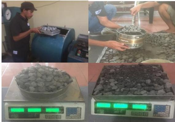
Gambar 10. Pengujian dengan mesin *Los Angeles*
