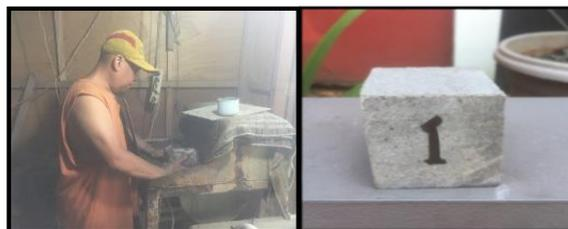
Gambar 7. Proses pemotongan sampel batuan
